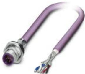
Встраиваемый разъем (вилка) шинной системы, DeviceNet/CANopen, 5-полюсный, M12, экранированный, с механическим ключом А-типа, монтаж с задней части стенки / резьбовое крепление с M16, с кабелем шины длиной 2 м, 2 x 0,2 мм<sup>2</sup>; 2 x 0,32 мм<sup>2</sup>
