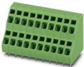
Клеммы для печатной платы, номинальный ток: 17,5 А, номинальное напряжение: 400 В, размер шага: 5,08 мм, полюсов: 6, тип подключения: Пружинный зажим, монтаж: Пайка волной припоя, направление подключения, проводник/печатная плата: 45 °, цвет: зеленый
