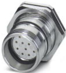
Приборный соединитель, задняя часть стенки, прямой, экранирован.: есть, Винтовой зажим, M23, Аксиальное уплотнительное кольцо, Центральное крепление M25 x 1,5, Толщина стенок, мин.: 0,8 мм, Толщина стенок, макс.: 6,5 мм
