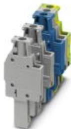
Штекер, номинальное напряжение: 500 В, номинальный ток: 24 А, тип подключения: Винтовые зажимы, количество точек подсоединения: 1, полюсов: 1, сечение: 0,14 мм<sup>2</sup> - 4 мм<sup>2</sup>, AWG: 26 - 12, ширина: 5,2 мм, высота: 47 мм, цвет: серый
