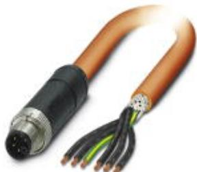
Силовой кабель, 6-полюсн., PUR без галогенов, оранжевый RAL 2003, экранирован. (Advanced Shielding Technology), Штекеры прямое M12, М-кодирование, к свободный конец, длина кабеля: 3 м, для переменного тока до 8 А / 690 В
