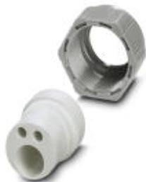
Составной резьбовой соединительный элемент Pg21, пластиковый, в комплекте с резиновым уплотнением с несколькими отверстиями (2 x 4,5 мм / 1 x 13 мм) и прижимной винтовой деталью, для переходных муфт сальника VC-M-KV-PG21...
