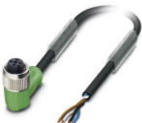
Кабель для датчика / исполнительного элемента, 4-полюсн., PUR/ПВХ, серый RAL 7001, свободный конец, к Гнездо угловой M12, А-кодирование, длина кабеля: 10 м
