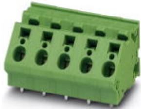
Клеммы для печатной платы, номинальный ток: 32 A, номинальное напряжение: 630 В, размер шага: 10 мм, полюсов: 12, тип подключения: Пружинный зажим, монтаж: Пайка волной припоя, направление подключения, проводник/печатная плата: 45 °, цвет: зеленый
