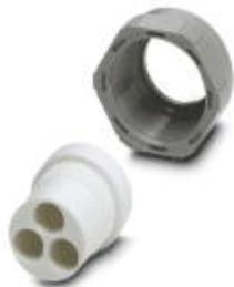
Резьбовой сальник Pg16 с частично нанесенной резьбой, пластмассовый, в комплекте с резиновым уплотнением с несколькими отверстиями (3 x 7 мм) и прижимной винтовой деталью, для переходных муфт сальника VC-M-KV-PG16...
