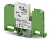
Релейный модуль со впаянными миниатюрными реле, позолоченный контакт для небольших нагрузок, 1 размыкающий контакт, входное напряжение 24 В DC
