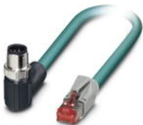
Сетевой кабель, Ethernet CAT5 (1 Гбит/с), 8-полюсн., PUR без галогенов, цвет морской воды RAL 5021, экранирован., Штекеры угловой M12 SPEEDCON / IP67, механические ключи: А, к Штекеры прямое RJ45 / IP20, длина кабеля: 0,5 м
