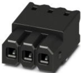
Корпусная часть для печатных плат, номинальный ток: 6 A, расчетное напряжение (III/2): 160 В, полюсов: 4, размер шага: 2,5 мм, цвет: черный, поверхность контакта: олово, монтаж: THR пайка, Артикул с защитными стопорными штифтами
