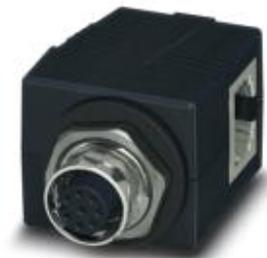
Компоненты для проходного монтажа на корпусе шкафа, M12, 8-полюсн., с механическим ключом А-типа на розетке RJ45, вход розетки 90°, IP65/67
