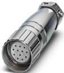
Кабельный соединитель, соединительная часть с резьбой Pg13,5, прямой, экранирован.: есть, Винтовой зажим, M23, Полясов: 16+3, тип контактов: Розетка, Подключение пайкой, диапазон диаметра кабеля: 9,5 мм ... 10,5 мм
