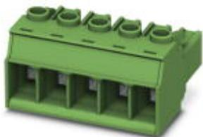
Разъемы для печатной платы, номинальный ток: 41 А, расчетное напряжение (III/2): 1000 В, полюсов: 4, размер шага: 7,62 мм, тип подключения: Винтовой зажим с натяжной гильзой, цвет: зеленый, поверхность контакта: олово
