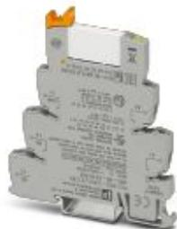
PLC-INTERFACE, в комплекте из базовой клеммы 6,2 мм, устанавливаемой на несущей рейке, с винтовым зажимом и вставного миниатюрного реле с силовым контактом 6А, 1 переключающего контакта, входное напряжение 120 В AC/110 В DC. Допуск согласно ATEX/IECEX (зона 2) и зоне Ex классу I, разделу 2.
