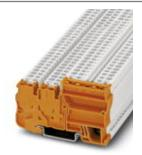
Клеммный модуль питания, номинальное напряжение: 250 В, номинальный ток: 30 А, тип подключения: Пружинный зажим, количество точек подсоединения: 4, сечение:  $0.08 \text{ мm}^2$  -  $4 \text{ мm}^2$ , AWG: 28 - 12, ширина: 10.4 мм, цвет: оранжевый, тип монтажа: NS 35/7.5, NS 35/15
