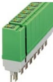
Вставное силовое полупроводниковое реле, со световым индикатором и защитной схемой во входной и выходной цепи, вход: 5 В пост.тока, выход: 24 - 280 В перем.тока/макс. 3 А, для вставки в базовые клеммные блоки
