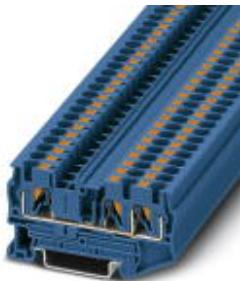
Проходные клеммы, номинальное напряжение: 800 В, номинальный ток: 32 А, тип подключения: Зажимы Push-in, количество точек подсоединения: 3, сечение: 0,2 мм<sup>2</sup> - 6 мм<sup>2</sup>, AWG: 24 - 10, ширина: 6,2 мм, цвет: синий, тип монтажа: NS 35/7,5, NS 35/15
