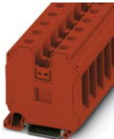
Проходные клеммы, номинальное напряжение: 1000 В, номинальный ток: 125 А, тип подключения: Винтовые зажимы, количество точек подсоединения: 2, сечение: 1,5 мм<sup>2</sup> - 50 мм<sup>2</sup>, AWG: 16 - 1/0, ширина: 16 мм, высота: 65,1 мм, цвет: красный, тип монтажа: NS 35/7,5, NS 35/15
