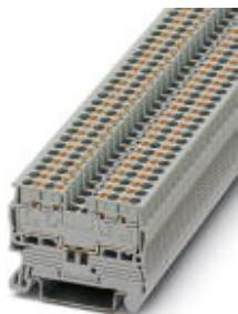
Проходные клеммы, с расширенными пазами для маркировки для ТМТ... Материал, номинальное напряжение: 500 В, номинальный ток: 17,5 А, тип подключения: Зажимы Push-in, количество точек подсоединения: 4, сечение: 0,14 мм<sup>2</sup> - 2,5 мм<sup>2</sup>, AWG: 26 - 12, ширина: 5,2 мм, высота: 35,3 мм, цвет: серый, тип монтажа: NS 35/7,5, NS 35/15
