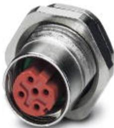
Встраиваемый штекер для датчика/исполнительного элемента, 4-контактный, M12-SPEEDCON, с механическим ключом D, с красным держателем контакта, установка на задней стенке/винтовое крепление, резьба M16, с прямым выводом под пайку
