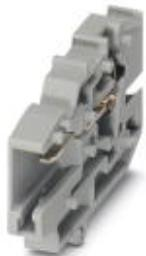
Соединитель COMBI, номинальное напряжение: 500 В, номинальный ток: 24 А, тип подключения: Пружинный зажим, количество точек подсоединения: 1, полюсов: 1, сечение: 0,08 мм<sup>2</sup> - 4 мм<sup>2</sup>, AWG: 28 - 12, ширина: 5,2 мм, высота: 21,8 мм, цвет: серый, тип монтажа: на монтажную пластину
