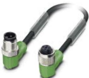
Кабель для датчика / исполнительного элемента, 3-полюсн., PUR без галогенов, темно-серый RAL 7021, Штекеры угловой M12, А-кодирование, к Гнездо угловой M12, А-кодирование, PIN 2+4 с перемычкой, длина кабеля: 3 м
