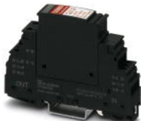
Разрядник для защиты от перенапряжений, устанавливаемый на монтажную рейку, для защиты абонентских устройств, индикатор неисправности на вставной части и контакт аварийной сигнализации на базовом элементе, состоит из двух частей. Исполнение: 48 В DC
