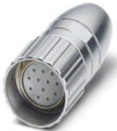
Кабельный соединитель, прямой, экранирован.: есть, Винтовой зажим, M23, Полосов: 12, тип контактов: Розетка, Подключение пайкой, диапазон диаметра кабеля: 3 мм ... 10,5 мм
