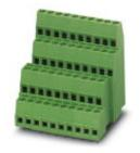
На рисунке показан 15контактный вариант сборки модуля Клеммы для печатной платы, номинальный ток: 15 А, номинальное напряжение: 400 В, размер шага: 5,08 мм, полюсов: 10, тип подключения: Винтовой зажим с натяжной гильзой, монтаж: Пайка волной припоя, направление подключения, проводник/печатная плата: 0°, цвет: зеленый
