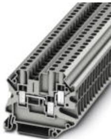
Проходные клеммы, номинальное напряжение: 1000 В, номинальный ток: 32 А, тип подключения: Винтовые зажимы, количество точек подсоединения: 3, сечение: 0,14 мм<sup>2</sup> - 6 мм<sup>2</sup>, AWG: 26 - 10, ширина: 6,2 мм, цвет: серый, тип монтажа: NS 35/7,5, NS 35/15
