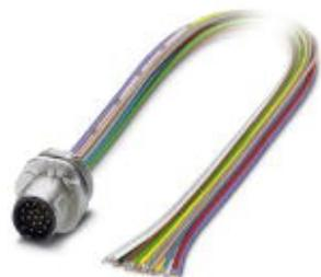
Встраиваемая вилка для датчика / исполнительного элемента, 17 контактов, M12-SPEEDCON, монтаж с передней части стенки / винтовое крепление с M16, с гибким проводом 0,5 м (изоляция из PVC), 17 x 0,14 мм<sup>2</sup>
