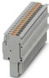
Штекер, номинальное напряжение: 500 В, номинальный ток: 17,5 А, тип подключения: Зажимы Push-in, количество точек подсоединения: 18, полюсов: 18, сечение: 0,14 мм<sup>2</sup> - 1,5 мм<sup>2</sup>, AWG: 26 - 14, ширина: 63 мм, высота: 31,3 мм, цвет: серый
