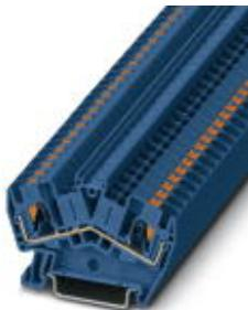
Проходные клеммы, номинальное напряжение: 800 В, номинальный ток: 32 А, тип подключения: Зажимы Push-in, количество точек подсоединения: 2, сечение: 0,2 мм<sup>2</sup> - 6 мм<sup>2</sup>, AWG: 24 - 10, ширина: 6,2 мм, цвет: синий, тип монтажа: NS 35/7,5, NS 35/15
