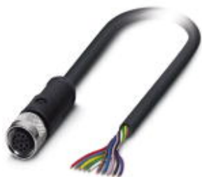
Магистральный кабель, 12-полюсн., PUR/ПВХ, черный RAL 9005, свободный конец, к Гнездо прямое M12, A-кодирование, длина кабеля: 10 м
