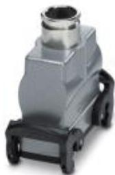
Соединительный корпус HEAVYCON B24, с двумя защелками, высота 81,5 мм, с резьбовым соединением 1x Pg29, прямой ввод кабеля
