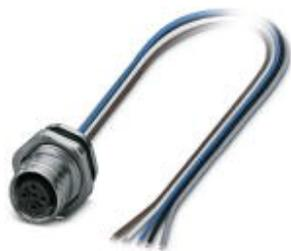
Встраиваемые разъемы, 5-полюсн., Гнездо, прямое, M12-Push-Pull, A-кодирование, Монтаж с внутренней стороны, M16 x 1,5, Отдельные проводники, длина кабеля: 0,5 м
