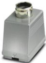
Корпус с кабельным сальником, крепление производится одной защелкой, высота 96 мм, с резьбовым соединением, 1x Pg36, прямое подключение кабеля
