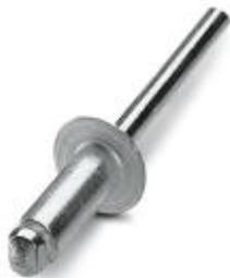
Закладная заклепка, Ø 4,0 мм, длина гильзы 14 мм, алюминиевая гильза, стальной оцинкованный пробойник, усеченная головка, стандартный вариант примерно как DIN 7337 A, также для UW/RW/PW 25
