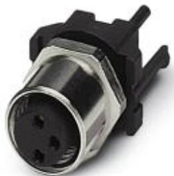
Встраиваемая гнездовая часть разъема для датчика / исполнительного элемента, 3 контакта, M8, монтаж с задней части стенки / винтовой монтаж с резьбой M8, защита от скручивания, с угловыми выводами под пайку, исполнение с выводами под пайку длиной 6 мм
