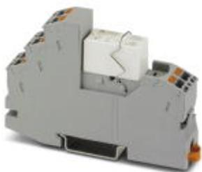
Предустановленный релейный модуль с разъемами push-in, состоящий из базового модуля, реле с силовыми контактами и металлического держателя. Исполнение контактов: 1 переключающий. Входное напряжение: 230 В AC
