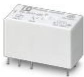
Вставное миниатюрное силовое реле с силовым контактом для высокого тока длит. нагрузки, 1 переключ. контакт, входное напряжение 230 В AC
