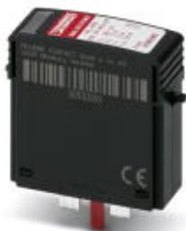
Штекер для защиты от перенапряжений типа 2 с последовательной схемой включения варистора и газонаполненного искрового промежутка для базового элемента VAL-MS, контроль перегрева, оптический индикатор неисправности. Исполнение: 350 В AC с повышенной пропускной способностью тока молний.
