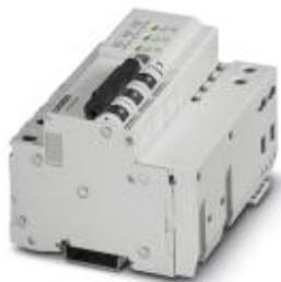
Комбинация из УЗИП класса II и входного предохранителя, с контролем разрядника и предохранителя, с индикатором состояния и контактом для дистанционной передачи сигнала. Исполнение: 4-проводные системы (L1, L2, L3, PEN), монтаж на рейку NS 35
