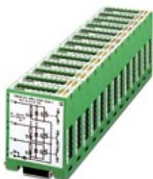
Релейный модуль, многоканальный, с 4 впаянными миниатюрными реле постоянного тока, со световым индикатором и 1 замыкающим контактом (на каждое реле), контакт для нагрузок от средних до больших, входное напряжение 24 В DC
