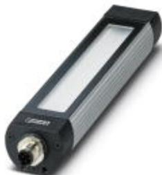
Светодиодный станочный светильник, 24 В DC, угол отражения 85 °/95 °, цветовая температура 5000 К, длина 190 мм, диаметр 40 мм, Штекерный соединитель M12, Корпус светильника: Алюминий, анодированный, Стекло: Однолистовое ударопрочное стекло (ESG, термически преднапряженное, термополированное стекло), поворотный, Стойкость к воздействию охлаждающих и смазочных материалов, возможность последовательного подключения
