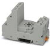
Цоколь реле RIF-3..., для октальных реле с 2 переключающими контактами, винтовой зажим, возможность установки входных модулей/модулей подавления помех, для монтажа на NS 35/7,5
