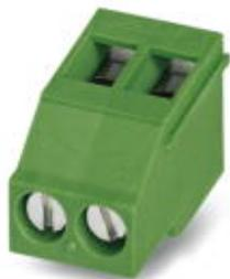
Клеммы для печатной платы, номинальный ток: 24 А, номинальное напряжение: 400 В, размер шага: 5,08 мм, полюсов: 2, тип подключения: Винтовой зажим с натяжной гильзой, монтаж: Пайка волной припоя, направление подключения, проводник/печатная плата: 90 °, цвет: зеленый. Возможна установка в ряд модулей с различным количеством полюсов (контактов)!
