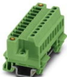
Штекер для установки на монтажную рейку, номинальный ток: 8 А, расчетное напряжение (III/2): 160 В, полюсов: 10, размер шага: 3,81 мм, тип подключения: Винтовой зажим с натяжной гильзой, цвет: зеленый, поверхность контакта: олово, монтаж: Монтажная рейка
