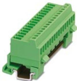
Штекер для установки на монтажную рейку, номинальный ток: 8 А, расчетное напряжение (III/2): 160 В, полюсов: 7, размер шага: 3,81 мм, тип подключения: Винтовой зажим с натяжной гильзой, цвет: зеленый, поверхность контакта: олово, монтаж: Монтажная рейка
