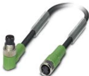
Кабель для датчика / исполнительного элемента, 3-полюсн., ПВХ, черный RAL 9005, Штекеры угловой M8, к Гнездо прямое M8, длина кабеля: 0,3 м
