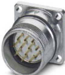
Приборный соединитель, передняя часть стенки, прямой, экранирован.: есть, Винтовой зажим, M23, Полосов: 17, тип контактов: Штифт, Обжим, Радиальное уплотнительное кольцо, 4x Ø2,7, Толщина стенок, мин.: 3 мм
