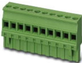
Разъемы для печатной платы, номинальный ток: 12 А, расчетное напряжение (III/2): 320 В, полюсов: 11, размер шага: 5,08 мм, тип подключения: Винтовой зажим с натяжной гильзой, цвет: зеленый, поверхность контакта: Золото
