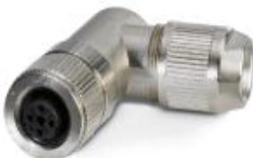
Шинный системный соединитель, Ethernet CAT5 (100 Мбит/с), 4-полюсн., экранирован., Гнездо угловой M12, с механическим ключом D-типа, Клеммы с ножевыми контактами, материал накатанной гайки: латунь, никелированный, наружный диаметр кабеля 4 мм ... 8 мм
